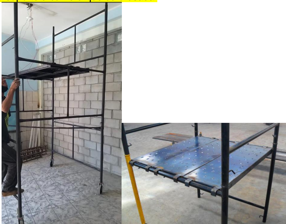
FIGURA 1 - MODELO DE ANDAIME E PLATAFORMA PERMITIDOS
