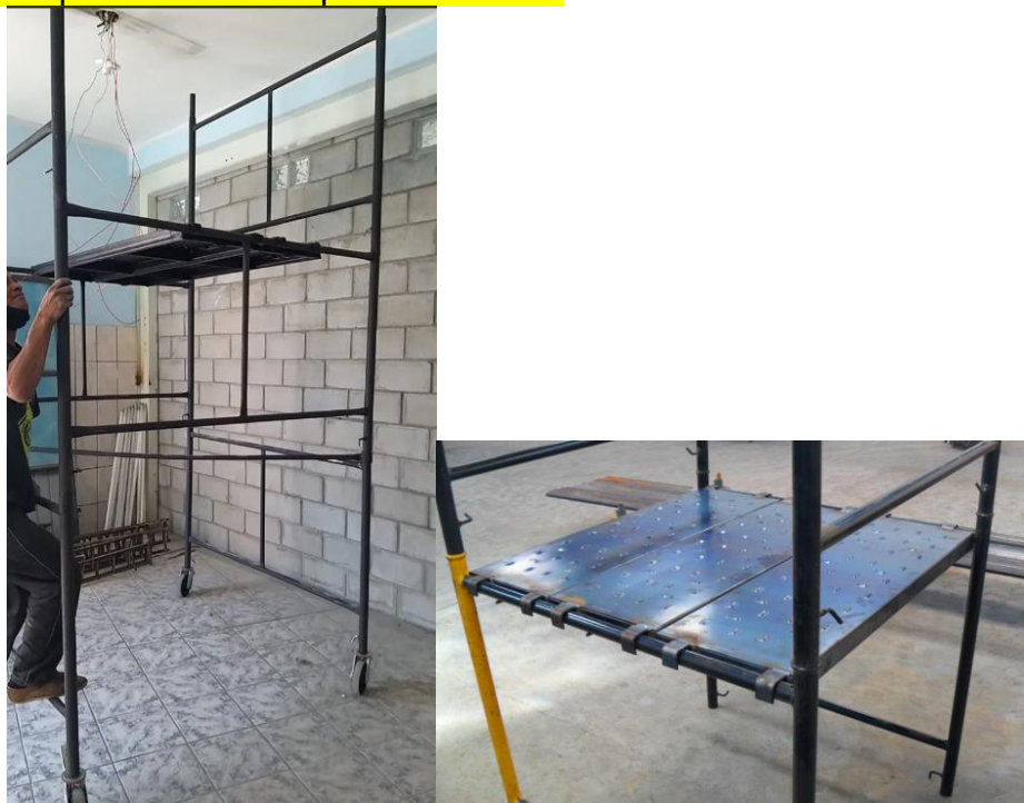
FIGURA 1 - MODELO DE ANDAIME E PLATAFORMA PERMITIDOS
